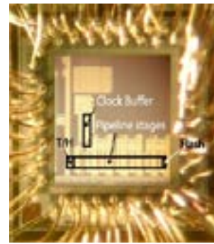
Snabbaste analog-digital-omvandlaren, ADC, för bredbandskommunikation som rapporterats. A 2.4 GS/s, 8 bit, enkanalig pipeline ADC i 65 nm CMOS.
